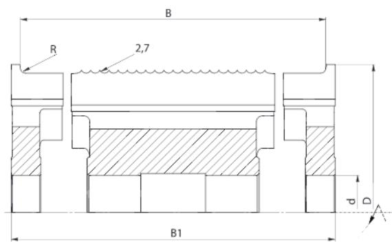
Набор фрез **FPO-03** – это насадные профильные фрезы с количеством зубьев  $z=4.0$  предназначены для профессиональной обработки древесины. Служат для профилирования террасной доски. С помощью прокладок осуществляется регуляция ширины обрабатываемого материала.
