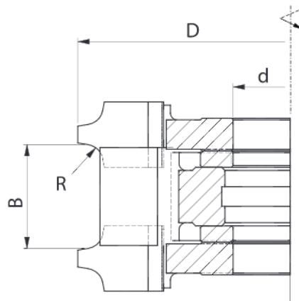
Набор фрез **FP-15** – это насадные профильные фрезы с количеством зубьев  $z=4.0$  предназначены для профессиональной обработки дерева и других древесных материалов, таких как ДСП, МДФ и других. Служат для закругления углов в материале. С помощью прокладок осуществляется регуляция ширины обрабатываемого материала.
