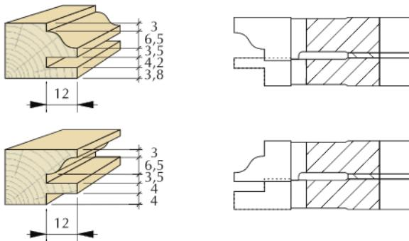
Набор фрез **FP-12** – это насадные профильные фрезы с количеством зубьев  $z=4.0$  предназначены для профессиональной обработки дерева и других древесных материалов, таких как ДСП, МДФ и других. Служат для профилирования односторонних мебельных дверей. С помощью прокладок осуществляется регуляция обрабатываемого материала. Одним набором можно создать несколько профилей.
