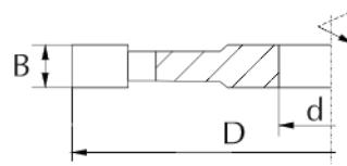
Фреза 3110 4.0 – это насадная прямая фреза с количеством зубьев  $z=4.0$  предназначена для профессиональной обработки дерева и других древесных материалов, таких как ДСП, МДФ и других. Целостная конструкция гарантирует точное позиционирование фрезы на вале станка. Ось резцов – параллельна оси инструмента.
