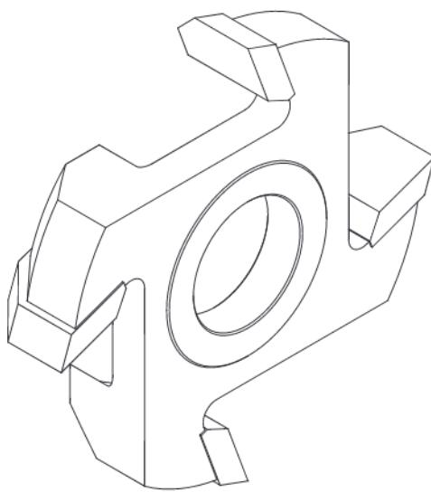
Боковые фрезы 6200 – это насадные профильные фрезы с количеством зубьев  $z=4.0$  предназначены для профессиональной обработки древесины. Работая вместе с основным набором 6200, служат для создания фасок в материале.
