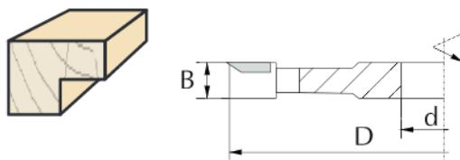
Фреза 3110-2 – это насадная прямая фреза с количеством зубьев  $z=2$   $v=2$  или  $z=4$   $v=4$ , то есть с 2 (4) режущими зубьями и с 2 (4) подрезающими зубьями с правой или левой стороны для прецизионной фальцовки. Фреза предназначена для профессиональной обработки дерева и других древесных материалов, таких как ДСП, МДФ и других. Целостная конструкция гарантирует точное позиционирование фрезы на вале станка.
