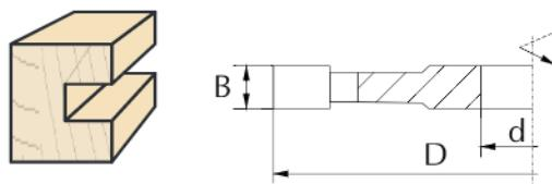
Фреза 3110 12.2 – это насадная прямая фреза с количеством зубьев  $z=12.2$  предназначена для профессиональной обработки дерева и других древесных материалов, таких как ДСП, МДФ и других. Целостная конструкция гарантирует точное позиционирование фрезы на вале станка. Ось резцов – попарно под углом оси инструмента. Это позволяет достичь высокого качества обрабатываемой поверхности. Большее количество зубьев дает возможность работать на высших подачах.
