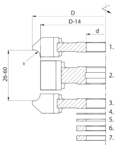
Набор фрез FP-06 – это насадные профильные фрезы с количеством зубьев  $z=4.0$  предназначены для профессиональной обработки дерева и других древесных материалов, таких как ДСП, МДФ и других. Служат для закругления углов и создания фасок в обрабатываемом материале. С помощью прокладок осуществляется регуляция ширины обрабатываемого материала. В этом наборе по сравнению с FP-05 увеличен диапазон регуляции.
